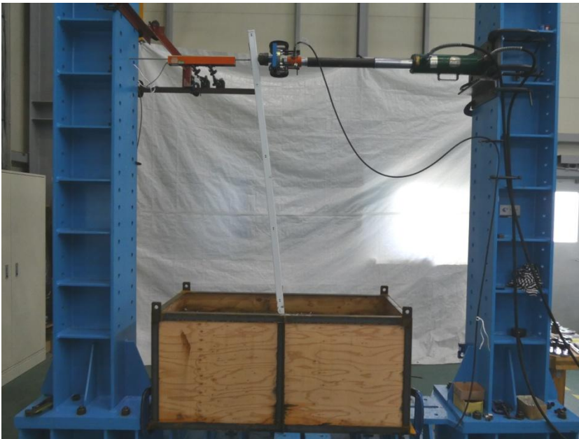
写真-2 試験体の状況（最大荷重時）
