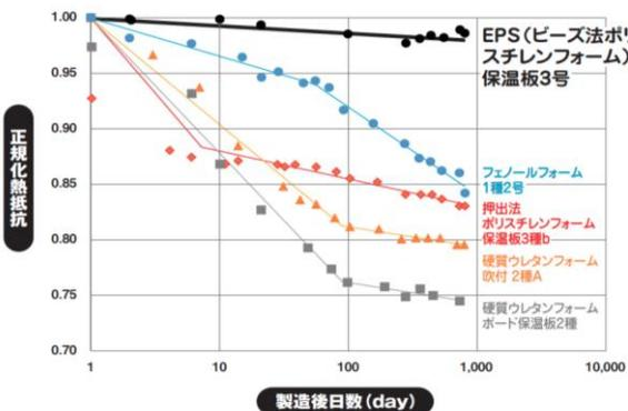
他の断熱材に比べて経時変化が大幅に少なく、
